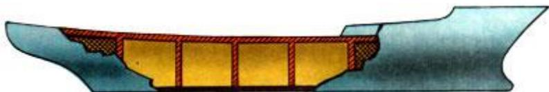
*Рис. 3. Разделение судна (модели) водонепроницаемыми переборками.*
